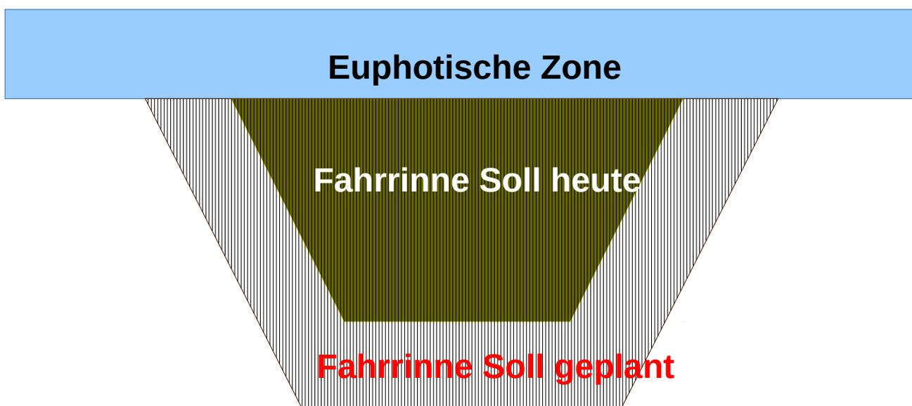
Für alle drei Ausbaustände wurde das Volumen des flachen, hellen Wassers gleich angesetzt.
